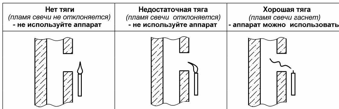
Рисунок 4. Способ проверки тяги в дымоходе
